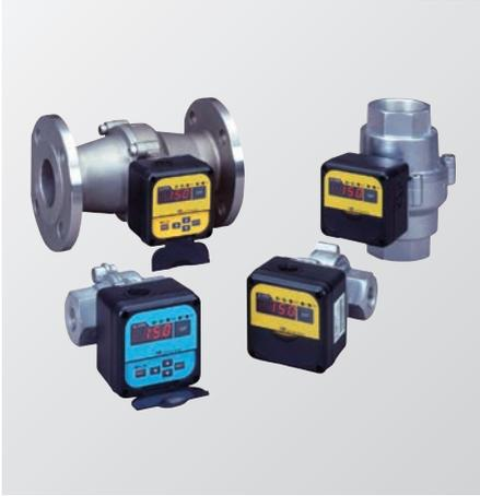
ガス流量モニタは、アズビル（株）独自開発の微小熱式流速センサを搭載した、ガスバーナの燃料・空気計測専用の質量流量計です。低圧力損失で瞬時流量・積算流量の表示・出力を備えており、ガスバーナの燃料使用量管理や空気比管理に最適です。
