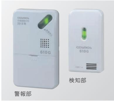
検知部と警報部を分離し、業務用の厨房等水のかかり易い場所での使用が可能です。警報遮断システム、集中監視盤等に接続できる外部出力付きです。検知部は防水構造。ランプと音声またはランプとブザーでお知らせします。(音声とブザーは切替可能)
