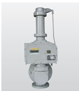
この補正装置は、圧力変化に応じ、特定の圧力（標準圧力または契約圧力）に自動的に補正し換算表示します。機械式なので防爆場所でも設置できます。また、高周波発信器が取り付けられるため、変換器を設けることでアナログ出力ができます。
