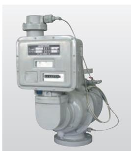
この補正装置は、温度・圧力変化に応じ、特定の基準状態に自動的に補正し換算表示します。機械式なので、防爆場所にも設置できます。また、高周波発信器が取り付けられるため、変換器を設けることでアナログ出力ができます。
