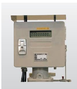
この補正装置は、温度・圧力変化に応じ、特定の基準状態に自動的に補正し換算表示します。電子式なので、現在温度、圧力、積算流量も確認でき、自己診断機能付です。また、電源は、リチウム電池を使用し通常7年作動します。
