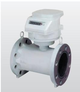
タービンガスメーターは、無給油方式を採用し、また、カートリッジ式タイプを選択することができ、メンテナンスが容易となります。
