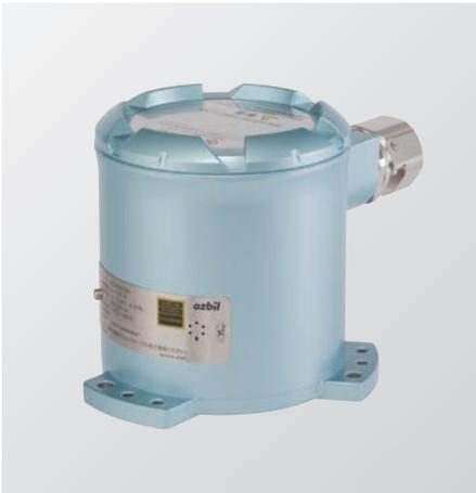
インテリジェント地震センサSES70は、地震動による被害を推定できるセンサです。内蔵された加速度ピックアップから出力される信号を用いて地震による建造物の被害状況を推定できるSI値並びに計測震度相当値、最大合成加速度を演算し出力します。
