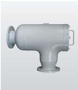
大容量メーターに使用するフィルターです。エレメントは、ポリビニルホルマールスポンジを濾材に応用したもので、構造は立体網状完全連続気孔となっています。コンパクトな形状で流量に対して低圧力損失を実現しています。カートリッジ式となっており、エレメント交換やエレメントの定期清掃が可能です。
