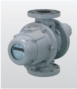
回転子を用いた実測式ガスメーターです。圧力損失も低く低圧から中圧まで高精度で大容量の計量ができ、都市ガス、LPガスなどの取引に使われるほか工場等の工程管理にも使われています。
