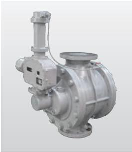
従来のルーツガスメーターの回転子を2層化することで、脈動を抑え、流量レンジを広げたルーツガスメーターです。カートリッジ式ルーツガスメーターは配管からメーターを取り外すことなく内機交換が可能です。従来の縦型配管設置に加え、水平配管による左右どちらからの流入にも対応しています。
