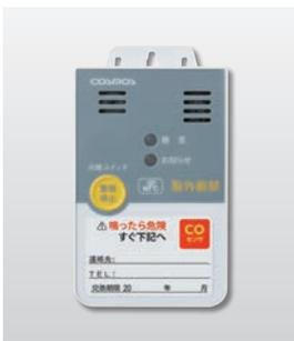
業務用厨房でのCO中毒防止のためにCOを検知してお知らせする機器です。血中のヘモグロビン(CO Hb)を推定することで一過性のCO発生では早鳴りせず、人体に危険な影響を与える環境に達する前に、ランプと音声で警報をお知らせします。
