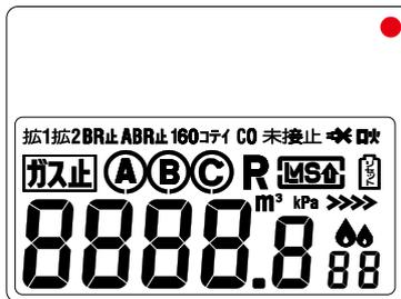
表示部には、大型液晶を搭載。セキュリティ表示や各種設定表示には、日本語と視認性の高い記号を採用しました。ひと目でお使いのメーターの設定状況の確認が可能になり、メーターのメンテナンス作業が容易になります。
