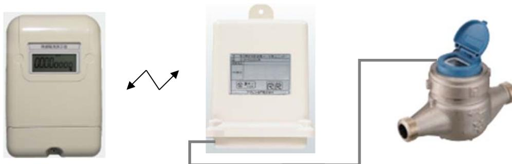
本製品は、水道メーター検針用システムにおいて、8ビット通信機能付電子式水道メーター（以下、メーター）を接続した無線検針装置メーター側ユニット（以下、メーター側ユニット）との無線通信により24時間毎の自動検針および磁石操作による検針を行い、メーターの積算値（隔測検針）、瞬間流量値、各種アラームを隔測で表示する無線隔測表示器（親機型）です。
